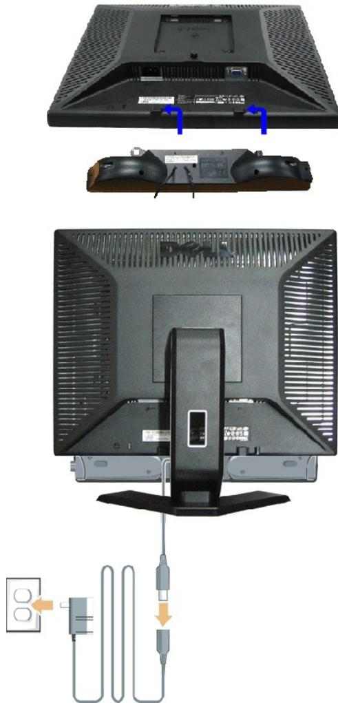
1. 在显示器的背面操作，将两个槽与显示器底部的两个卡舌对齐，装入 Soundbar。
